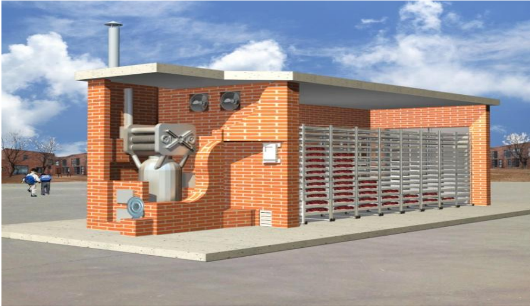
2吨/批（总干燥面积 200m 2 ）燃煤加热式热风烘房剖视示意
